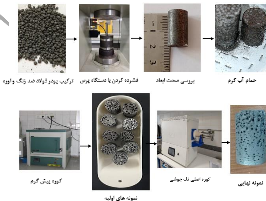
شکل ۲: نمایش نحوه فرآیند تولید فوم فولاد ضد زنگ‌زن.
