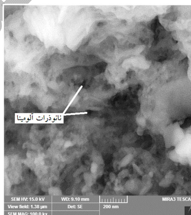
شکل ۸- تصویر میکروسکوپ الکترونی روبشی از نانوذرات آلومینا قرار گرفته در دیواره سلول‌ها.
