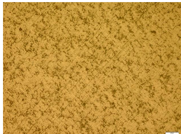
شکل ۲ تصویر میکروسکوپ نوری از نمونه ریخته‌گری شده -Al5083 5wt%. ZrB 2
