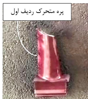
شکل ۷ نتایج آزمون مایع نافذ بر روی پره متحرک ردیف اول از جنس IN738LC در توربین گازی کلاس E مدل زمینس V94.2
