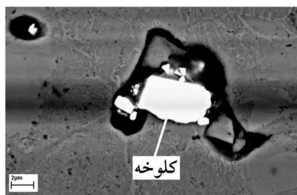
شکل ۷ تصویر میکروسکوپ الکترونی روبشی از نمونه فولادی حاوی ۴ درصد وزنی کاربید تنگستن که نمایش دهنده کلوخه‌ای شدن ذرات تقویت کننده در زمینه فولادی است
