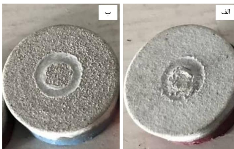
شکل ۱۱ تصویر سطح نمونه‌ها پس از انجام آزمون سایش تحت نیروی ۱۰ نیوتن: (الف) آلومینای میکرونی، (ب) کامپوزیت \text{Al}_2\text{O}_3\text{-}20\%\text{Y}_2\text{O}_3 میکرونی
