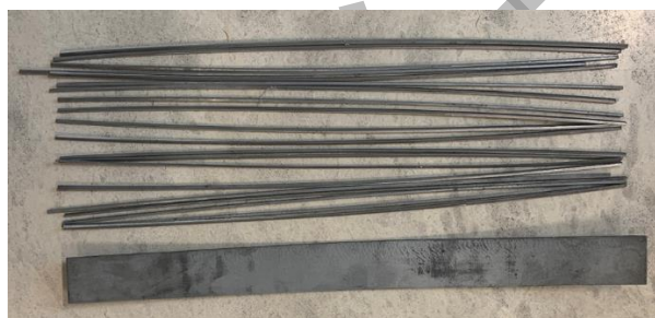
شکل ۴- نمونه سنگ‌زده شده و ورق به دست آمده بعد از عملیات نورد گرم و نمونه‌های مفتول برش داده شده از ورق
