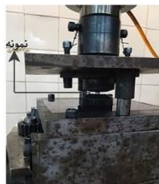
شکل ۲- الف- مجموعه استفاده شده جهت انجام فرآیند پیچش تحت فشار بالا ب- مجموعه قالب استفاده شده جهت انجام فرآیند پیچش تحت فشار بالا و نمونه که در داخل قالب قرار گرفته است.
