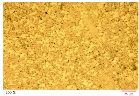
شکل ۱۲ تصویر میکروسکوپ نوری نمونه ۵ (حاوی ۲/۵٪ حجمی B_4C و ۲/۵٪ حجمی TiB_2 )
