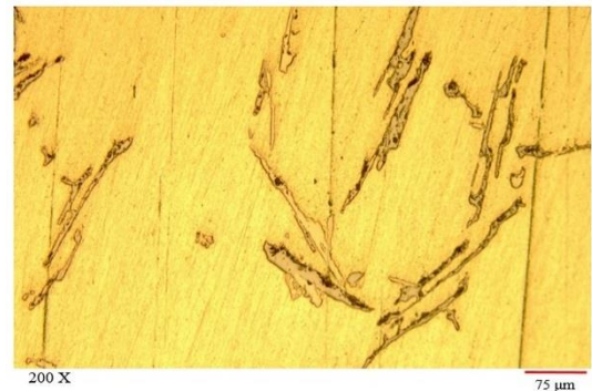
شکل ۸ تصویر میکروسکوپ نوری نمونه ۲ (حاوی ۲/۵٪ حجمی B 4 C) بعد از عملیات T6
