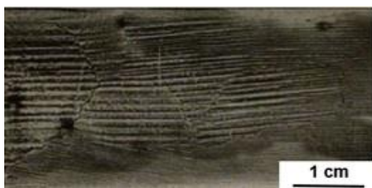
شکل ۴: نمایی از سطح ورق فولاد سیلیکونی پس از اعمال سوسپانسیون و ظهور حوزه‌های مغناطیسی برای اندازه‌گیری متوسط عرض آن
