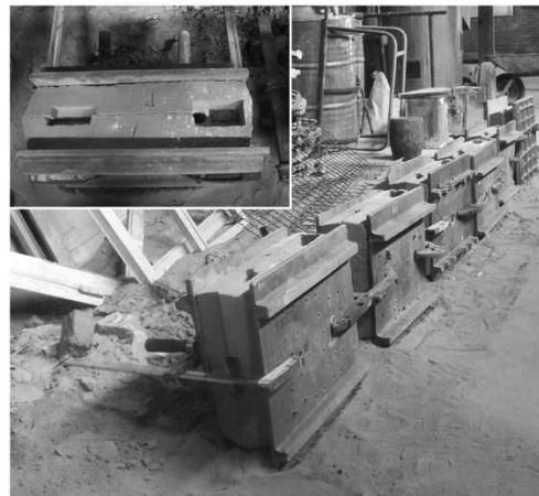
شکل ۲ قالب‌های آماده شده برای ریختن مذاب
