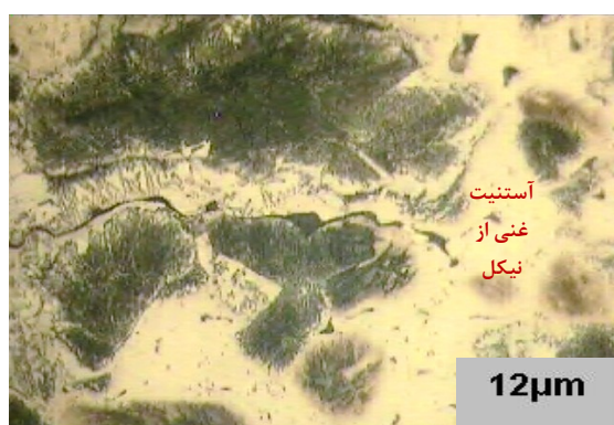
شکل ۵ ریزترک‌های مشاهده شده در فولاد D.HP همراه با نواحی آستنیتی غنی از نیکل
