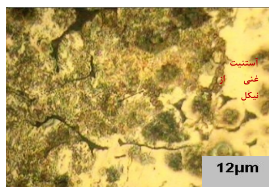
شکل ۵ ریزترک‌های مشاهده شده در فولاد D.HP همراه با نواحی آستنیتی غنی از نیکل
