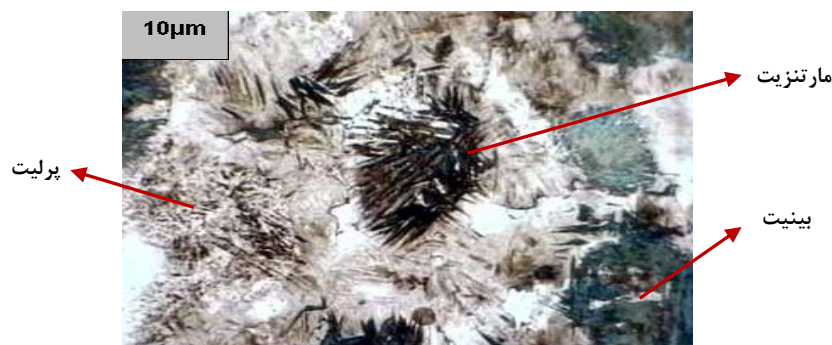
شکل ۲ ریزساختار کلی فولاد D
