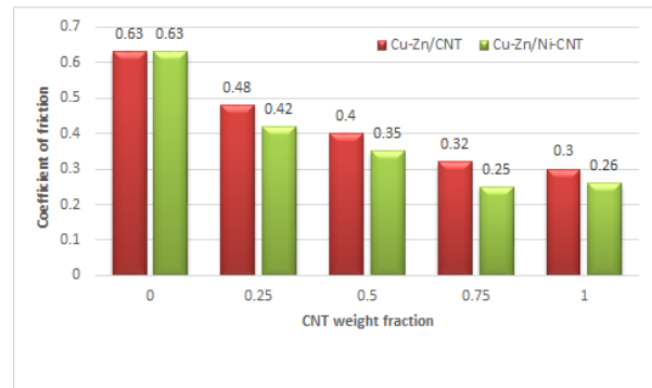
شکل ۳ ضریب اصطکاک نانوکامپوزیت تقویت شده با نانو لوله های پوشش داده شده با نیکل و بدون نیکل در سرعت سایش 0.9 متر بر ثانیه
