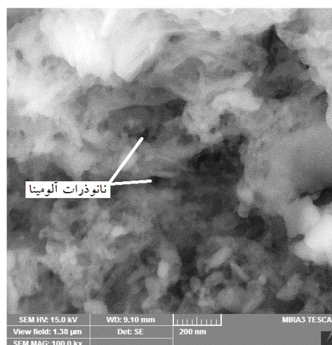
شکل ۸ تصویر میکروسکوپ الکترونی روبشی از نانوذرات آلومینا قرار گرفته در دیواره سلول‌ها
