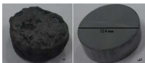
شکل ۱ تصویر نمونه فشرده (الف) قبل از سنتز؛ (ب) پس از سنتز با استفاده از پودر گرافیت به عنوان ماده جاذب
