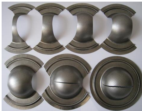
شکل ۹ نمونه‌های آزمایش ناکازیمما در لحظه گلوئی یا پارگی
