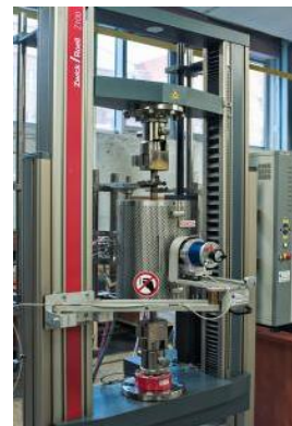
شکل ۱ دستگاه آزمون یونیورسال کشش و فشار ZwickRoell مدل Z250 با کوره الکترونیکی
