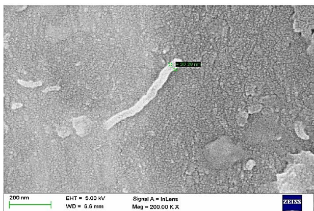
شکل ۲ تصویر SEM از Cu-5Zn-0.25%CNTs بعد از تف‌جوشی و آهنگری
