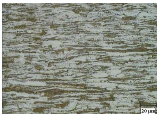
شکل ۳ تصویر میکروسکپ نوری از ریزساختار نمونه ۷۰ درصد نورد شده و تاب کاری شده در دمای ۷۴۰ درجه سانتیگراد به مدت ۳۰ ثانیه (عدم وقوع تبلور مجدد)
