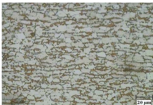
شکل ۹ تصویرهای میکروسکپ نوری از ریزساختار نمونه‌های فولادی ۷۰ درصد کار سرد شده برای مدت زمان ۵ دقیقه در دمای ۷۴۰ درجه سانتیگراد
