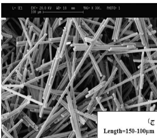
شکل ۲ تصویر میکروسکوپ الکترونی روبشی الیاف کربن قبل از فرآیند سینتر با جرقه پلاسما
