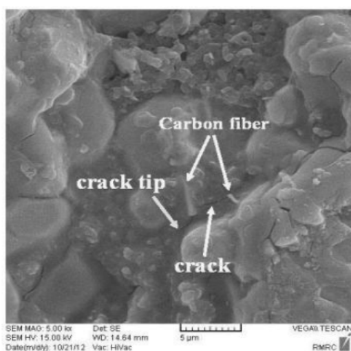
شکل ۱۰ انحراف ترک وقتی به الیاف کربن می‌رسد [11]
