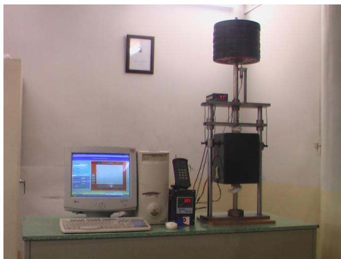
شکل ۲ تصویر دستگاه خزش ساخته شده در این تحقیق
