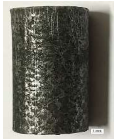
شکل ۲ نمونه تولیدشده اولیه بعد از مرحله فشردن
