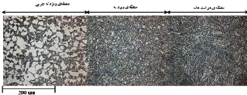
شکل ۳ تغییرات ریزساختار در امتداد منطقه‌ی متأثر از گرما در فولاد کم‌آلیاژ
