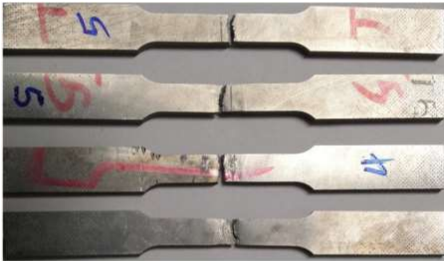
شکل (۱۳) تصویر نمونه‌های جوش شده به روش TIG پس از شکست در آزمون کشش
