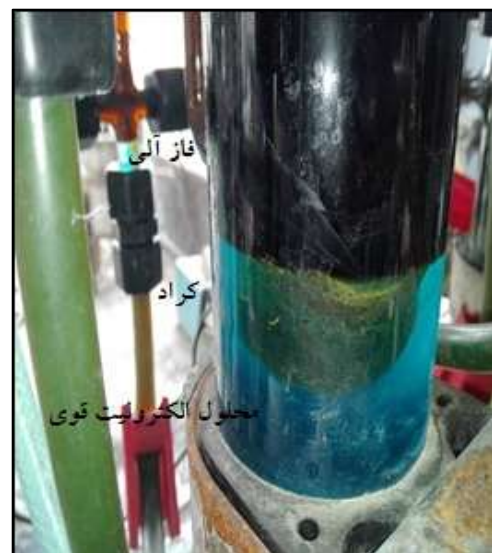
شکل (۳) کراد تشکیل شده در مرحله تهی‌سازی در حین آزمایش با محلول مصرف شده کارخانه
