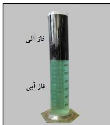
شکل (۲) فاز آبی و فاز آلی داخل ستلر مرحله تهی‌سازی پس از آزمایش پیوسته اول
