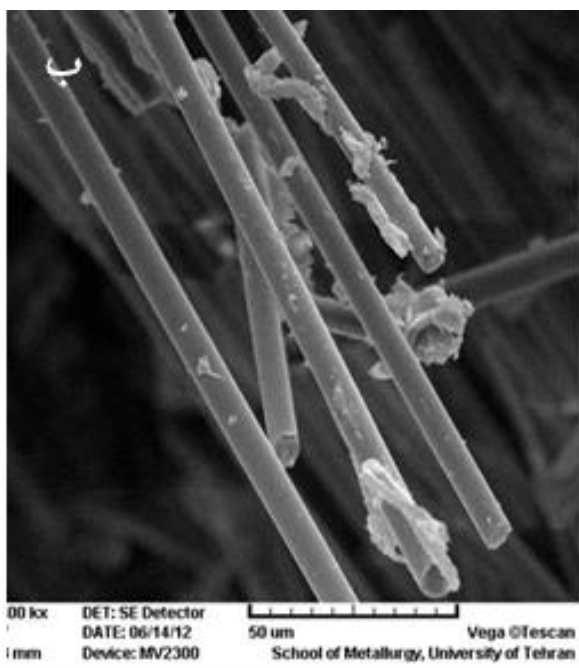
شکل ۶ (الف) سطح مقطع شکست، (ب) الیاف شکسته شده در نمونه حاوی ۰/۵ درصد نانوذرات رس
