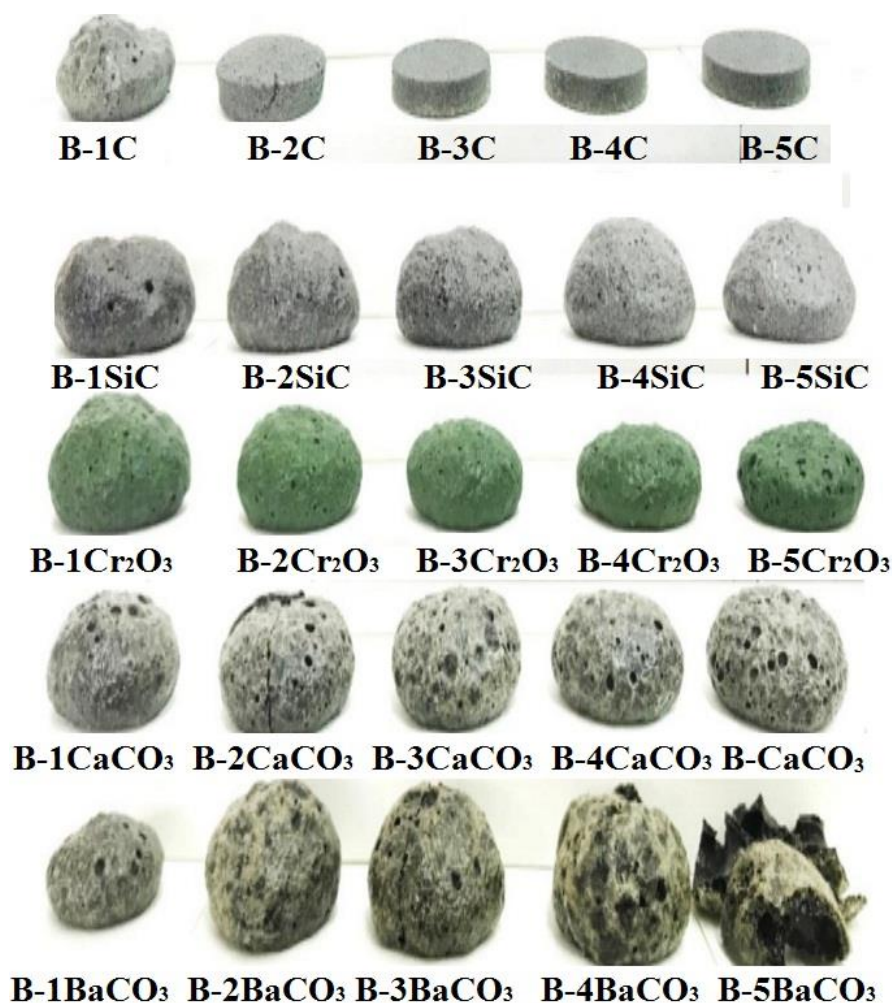
شکل ۴ ظاهر نمونه های کامپوزیت بعد از زینتر در دمای ۱۲۰۰ درجه سانتی گراد
