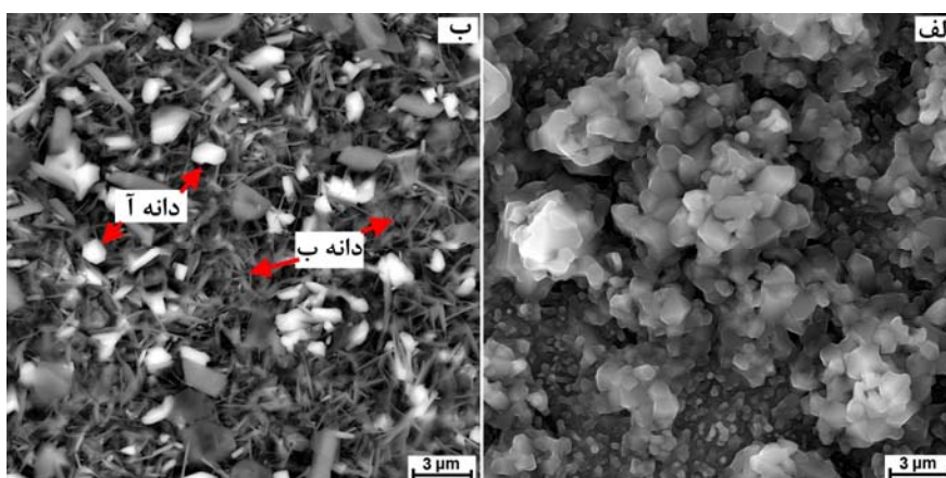
شکل ۱۰ تصویرهای میکروسکوپ الکترونی روبشی از سطوح ترکیبات Ti-48Al (الف) و Ti-48Al-5Mn (ب) اکسید شده به مدت ۸ ساعت در دمای 900^{\circ}\text{C}
