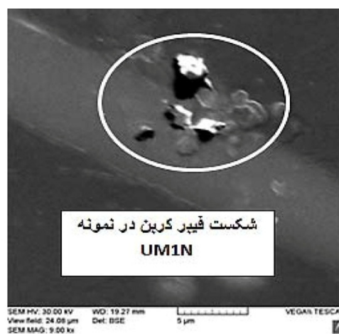
شکل ۶ تخریب الیاف کربن در نمونه‌ی ماده‌ی مرکب UM1N
