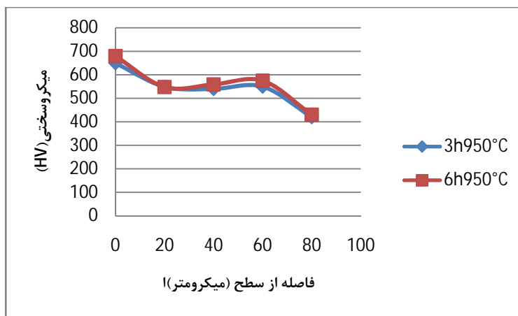
شکل ۹ نمودار تغییر سختی بر حسب فاصله از سطح پوشش مربوط به نمونه‌ی حرارت‌دهی شده در دمای ۹۵۰ °C به مدت زمان‌های ۳ و ۶ ساعت
