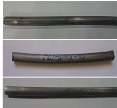
شکل ۵ نمونه‌ای میله‌های از اکستروژن شده در این تحقیق
