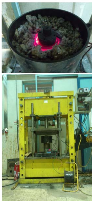
شکل ۳ دستگاه اکستروژن مورد استفاده در این تحقیق شامل کوره و پرس هیدرولیک ۶۰ تن
