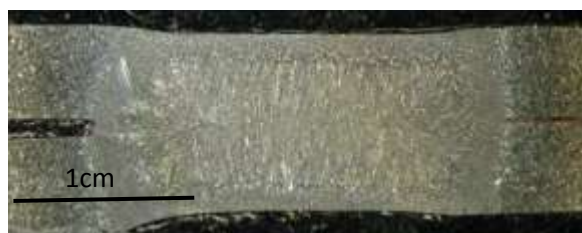
شکل ۷ ماکروساختار نمونه جوش اتصال مشابه M/M
