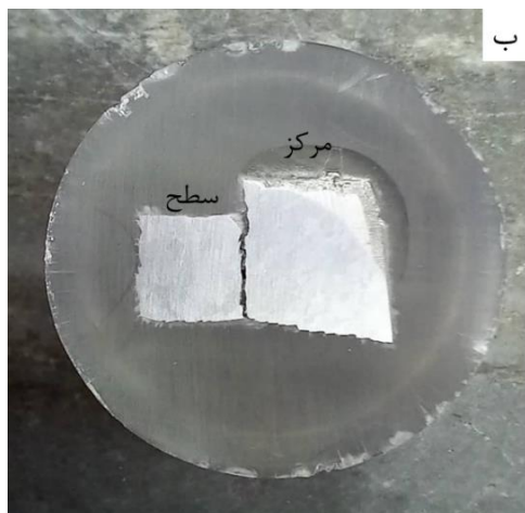
شکل ۳ تصاویر نمونه‌های استخراج شده از سطح و مرکز شمش‌های ریخته شده در (الف) شرکت بلوچ آلومینیوم و (ب) شرکت ایرالکو
