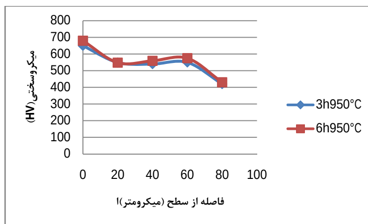
شکل ۹ نمودار تغییر سختی بر حسب فاصله از سطح پوشش مربوط به نمونه‌ی حرارت‌دهی شده در دمای 950^{\circ}\text{C} به مدت زمان‌های ۳ و ۶ ساعت
