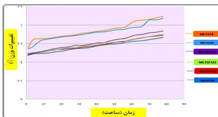
شکل ۱۵ نمودار تغییرات وزن بر حسب زمان نمونه‌های  $\text{MC}_{35}\text{Z}_8$  و  $\text{MC}_{35}\text{F}_4\text{Z}_2$ ,  $\text{MC}_{35}\text{F}_3\text{Z}_2$ ,  $\text{MC}_{35}\text{F}_3\text{Z}_3$ ,  $\text{MC}_{35}\text{F}_4\text{Z}_3$ ,  $\text{MC}_{35}\text{Z}_6$ ,  $\text{MC}_{35}\text{F}_8$  و  $\text{MC}_{35}\text{F}_4\text{Z}_2$  زیتر شده در دمای  $165^{\circ}\text{C}$
