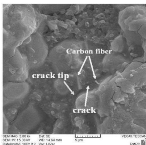
شکل ۱۰ انحراف ترک وقتی به الیاف کربن می‌رسد [11]
