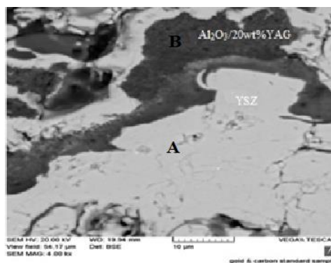
شکل ۴ تصویر میکروسکوپ الکترونی روبشی شامل منطقه خاکستری روشن (YSZ) و منطقه خاکستری تیره ( \text{Al}_2\text{O}_3/20\text{wt}\%\text{YAG} )
