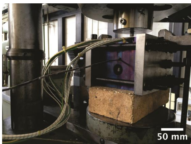
شکل ۱. نمایی از قالب مورد استفاده در فرآیند فشردن در کانال زاویه‌دار با مقاطع یکسان و تجهیزات مربوط به آن
