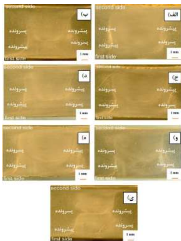
شکل (۳) مقطع عرضی از ناحیه جوش در سرعت‌های سیر و چرخش معروف هستند، که در اثر حکاکی این ناحیه پدیدار می‌شوند، مشاهده نمی‌شود. این حلقه‌ها در اثر تغییرات اندازه دانه‌ها، بافت و چگالی نابجایی‌ها در ناحیه اغتشاش شکل می‌گیرند. از جمله عوامل تأثیرگذار در شکل‌گیری این حلقه‌ها می‌توان به هندسه ابزار، سرعت چرخش و سرعت سیر اشاره نمود [7]. گزارش شده است که این حلقه‌ها موجب تضعیف خواص مکانیکی ناحیه اتصال می‌شود [4]. با مشاهده در تصاویر درشت‌ساختاری به‌خصوص شکل (۳-ی) که دو طرف اتصال همپوشانی با یکدیگر ندارند مشاهده می‌شود که ناحیه اغتشاش نسبت به مرکز اتصال متقارن است و با حرکت از مرکز اتصال به سمت ناحیه فلز پایه و در سمت پسرونده، ناحیه اغتشاش کم‌رنگ می‌شود، درحالی‌که در سمت
