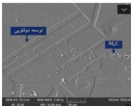
شکل (۱۰) ریزساختار SEM آلیاژ Haynes 188 پس از نورد گرم با کاهش ضخامت ۸۵٪ و آنیل انحلالی در دمای ۱۱۶۰ °C (الف) ۳۰ دقیقه، (ب) ۶۰ دقیقه
