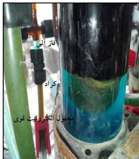
شکل (۳) کراد تشکیل شده در مرحله تهی‌سازی در حین آزمایش با محلول مصرف‌شده کارخانه
