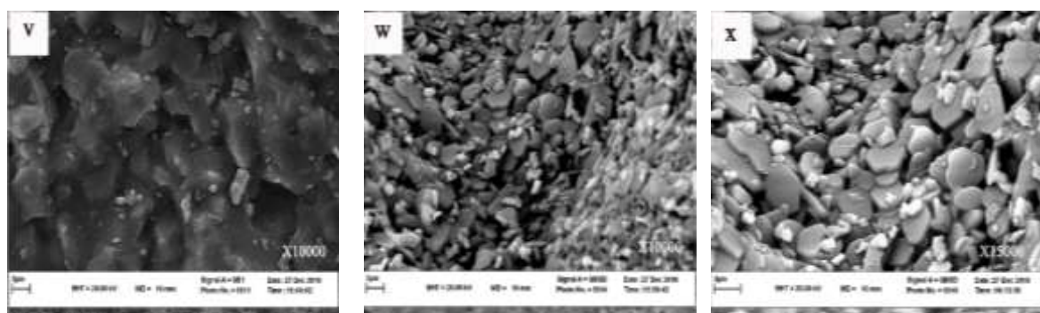
شکل (۸) نمونه‌های عملیات حرارتی شده در دمای 1500^{\circ}C ، تصاویر s، مربوط به نمونه E1-1500 با نسبت (۳:۲)، تصاویر u، v مربوط به نمونه E2-1500 با نسبت (۳:۴)، تصاویر w، x مربوط به نمونه E3-1500 با نسبت (۲:۱)
