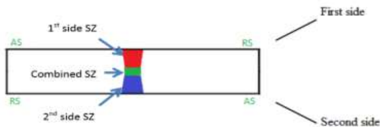
شکل (۲) شماتیکی از فرایند جوشکاری اصطکاکی اغتشاشی دوطرفه مورد استفاده در این تحقیق
