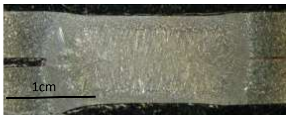
شکل ۷ ماکروساختار نمونه جوش اتصال مشابه M/M
