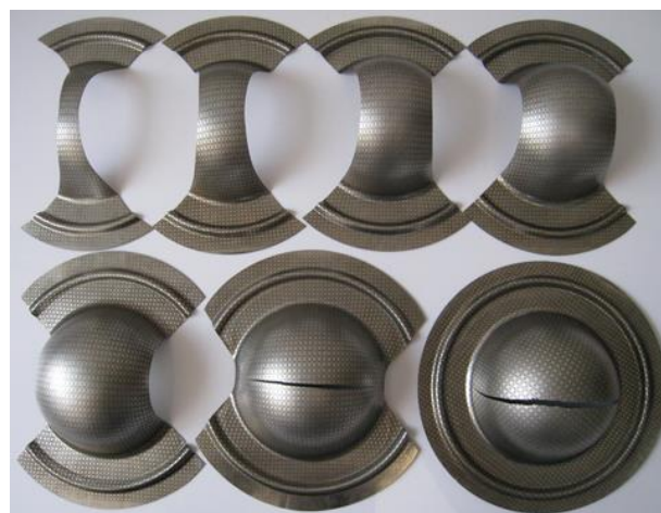
شکل ۹ نمونه های آزمایش ناکازیم در لحظه گلوپی یا پارگی
