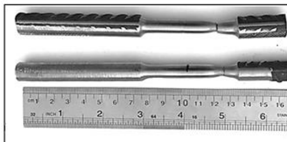
شکل ۱۲ شکستگی اتصال جوش داده شده پس از ماشین‌کاری در فلز پایه
