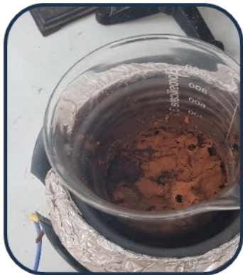
شکل ۲ کاتالیست \text{MgFe}_2\text{O}_4 سنتز شده به روش احتراقی با سوخت گلايسين
