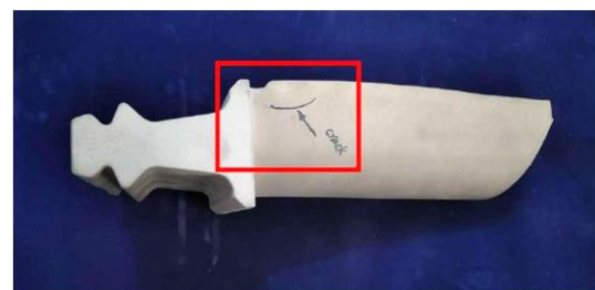
شکل ۶ تصاویر ظاهری از پره متحرک ردیف اول از جنس IN738LC در توربین گازی کلاس E مدل زمینس (SGT5-2000E) V94.2
