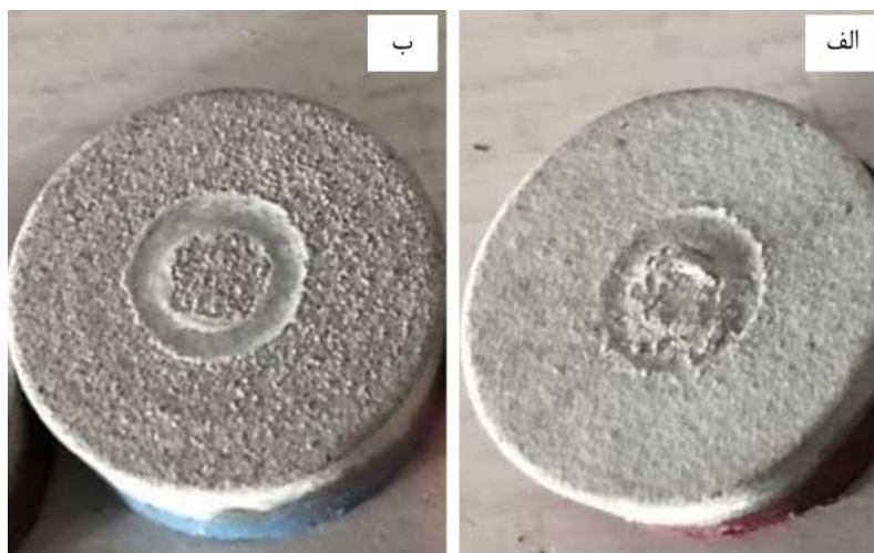
شکل ۱۱ تصویر سطح نمونه‌ها پس از انجام آزمون سایش تحت نیروی ۱۰ نیوتن: (الف) آلومینای میکرونی، (ب) کامپوزیت \text{Al}_2\text{O}_3 -20% \text{Y}_2\text{O}_3 میکرونی
