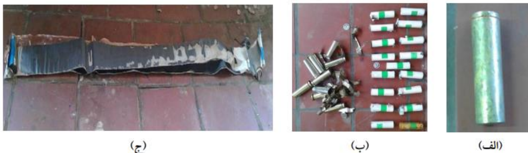
شکل ۴ پیاده‌سازی اجزای سلول‌های لیتیوم - یون: (الف) یک نمونه سلول باتری قبل از عملیات پیاده‌سازی، (ب) سلول‌های باتری بعد از بریدن محفظه فولادی و خارج کردن محتویات آن و (ج) محتویات باتری شامل آند، کاتد، جداکننده و محفظه فولادی [59]
